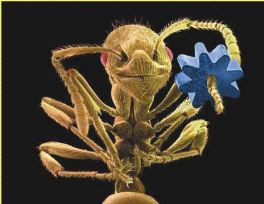
Цветное сканирование муравья, держащего микроскопический механизм шириной 0,1 мм.
